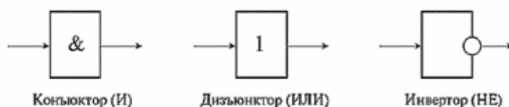
Рис. 3.1. Обозначения базовых логических элементов
