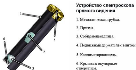
Рисунок 9.1 – Устройство спектроскопа прямого зрения
